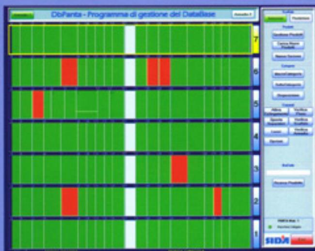
Nelle visualizzazioni di struttura vengono evidenziate le posizioni dei separatori e lo stato di disponibilità delle sezioni.
